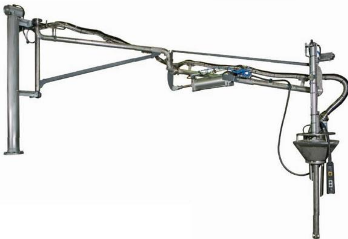
Прибор налива с отводом паров
