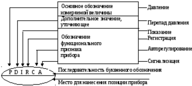
Рис. 9.2 Принцип построения условного обозначения прибора
