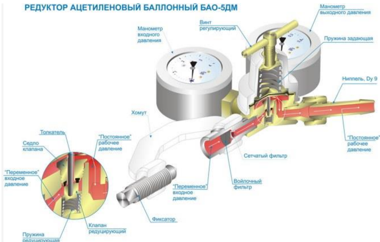
Устройство ацетиленового редуктора
