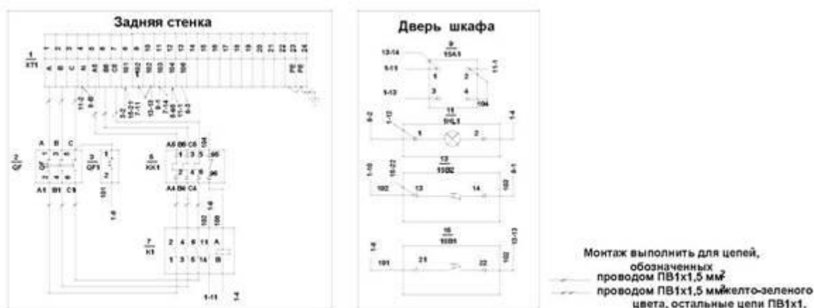
управления местного уровня (ЩМУ1) показан на рис.58. Расположение аппаратуры на схеме примерно соответствует фактическому размещению в конструкции шкафа. Рядом с каждым аппаратом проставлен порядковый номер и позиционное обозначение. Так, возле клеммной колодки - 1/XT1, вводного автоматического выключателя - 2/QF и т. д. Внутри каждого элемента проставлена нумерация выводов, соответствующая заводской маркировке. Монтаж силовых цепей показан прямым соединением проводников между аппаратами. Соединения цепей управления выполнены адресным методом. Так, электрическая цепь 104 (пример лекции 16, рис. 33 ) выполнена следующим образом.
