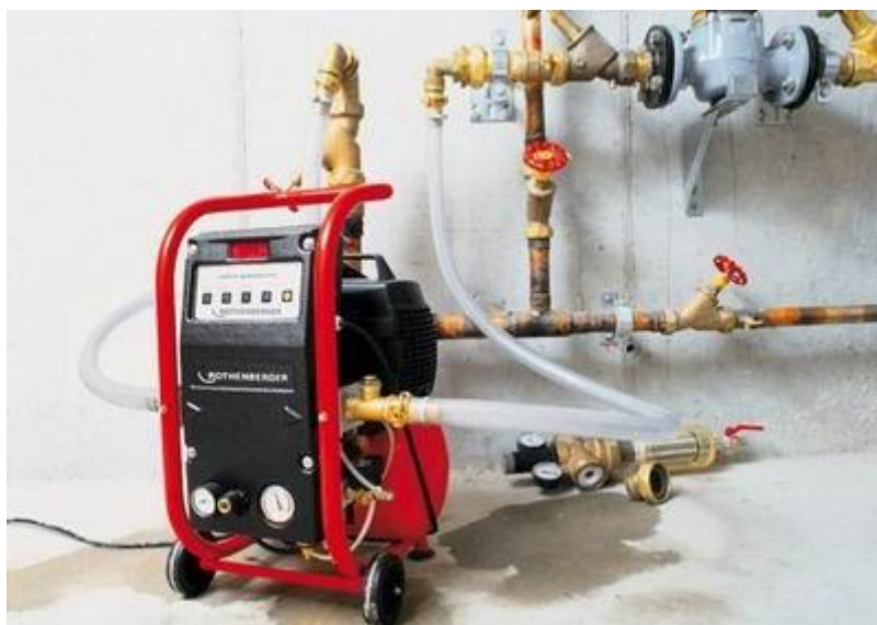
Воздушный компрессор для опрессовки систем водоснабжения или отопления
